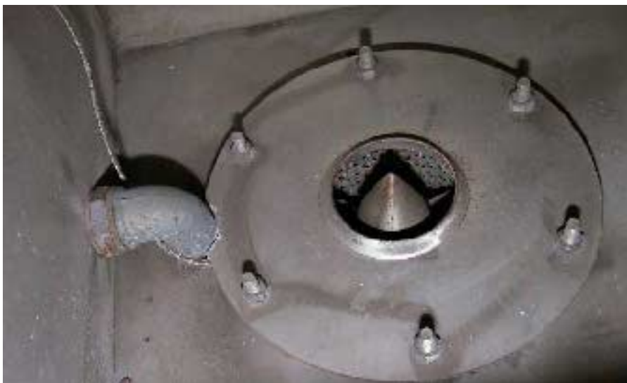
Bild 7.1-2: Filterelement mit Abdeckblech und Heizelement/ Strömungsleiteinrichtung
