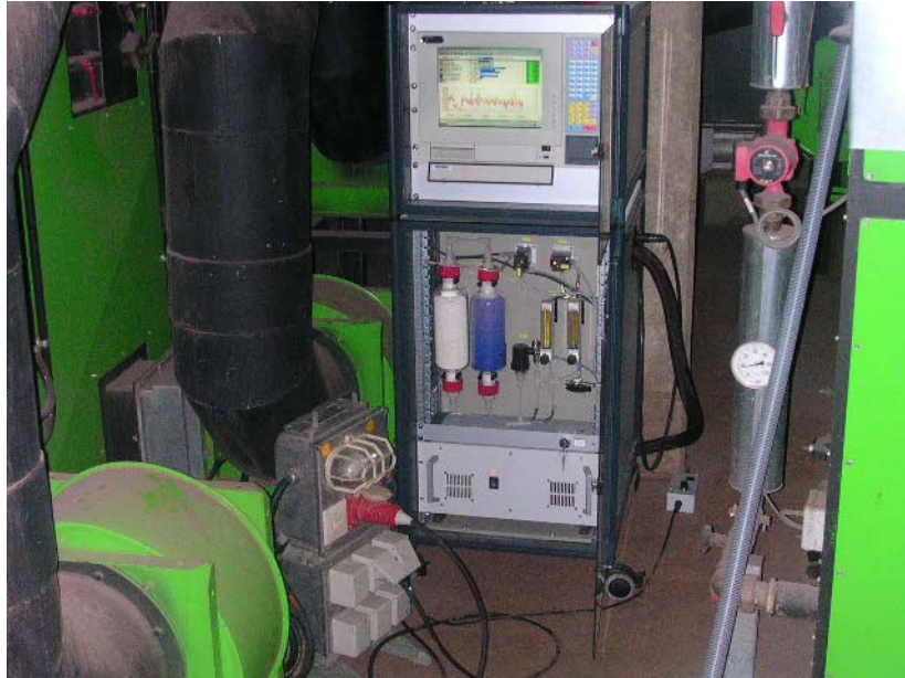
Bild 6.3-3: FTIR- Analysator zur quantitativen Bestimmung der Gaskomponenten
