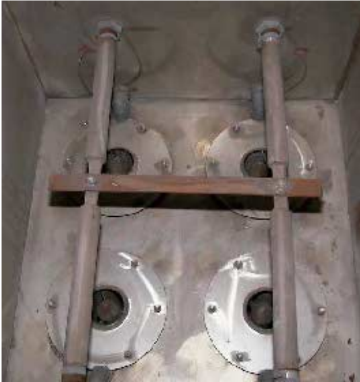
Bild 7.1-3: Reingasraum mit geringen Staubspuren
