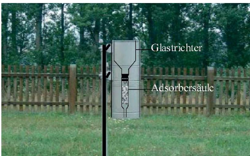
Abb. 9: Probenahme der atmosphärischen Deposition organischer Spurenstoffe mittels Trichter-Adsorber-Verfahren
