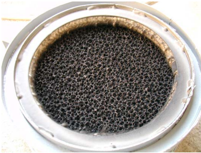
Abb.6: Ansicht des beaufschlagten Filtermaterials
