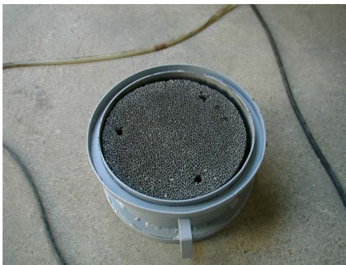
Abb.5: beaufschlagter Filter im Filterhalter
