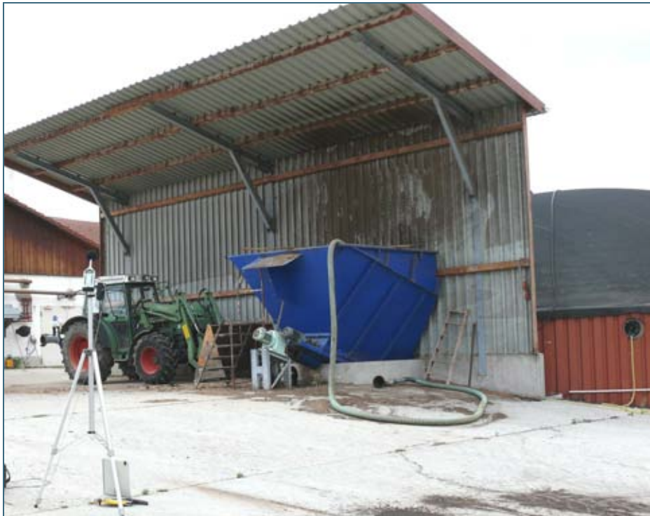
Abb. 28: Beispiel für einen ab- geschirmten Substrat- dosierer
