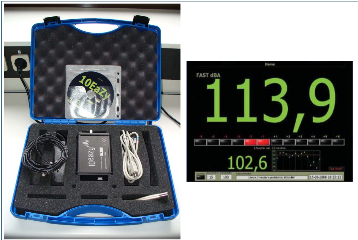
Abb. 10: Messsystem 10EaZy von ROGA-Instruments mit Schallpegelmessgerät (links) und softwarebasierter Bildschirmanzeige (rechts)
