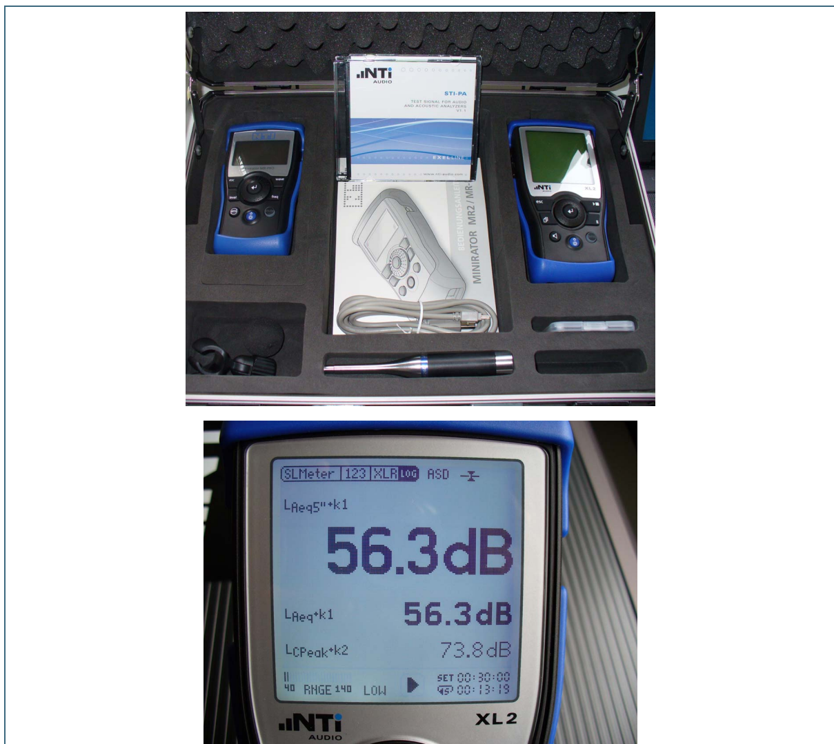
Abb. 8: Schallpegelmesser XL2 Analyzer (oben) von NTI und Schallpegelanzeige im Display (unten)
