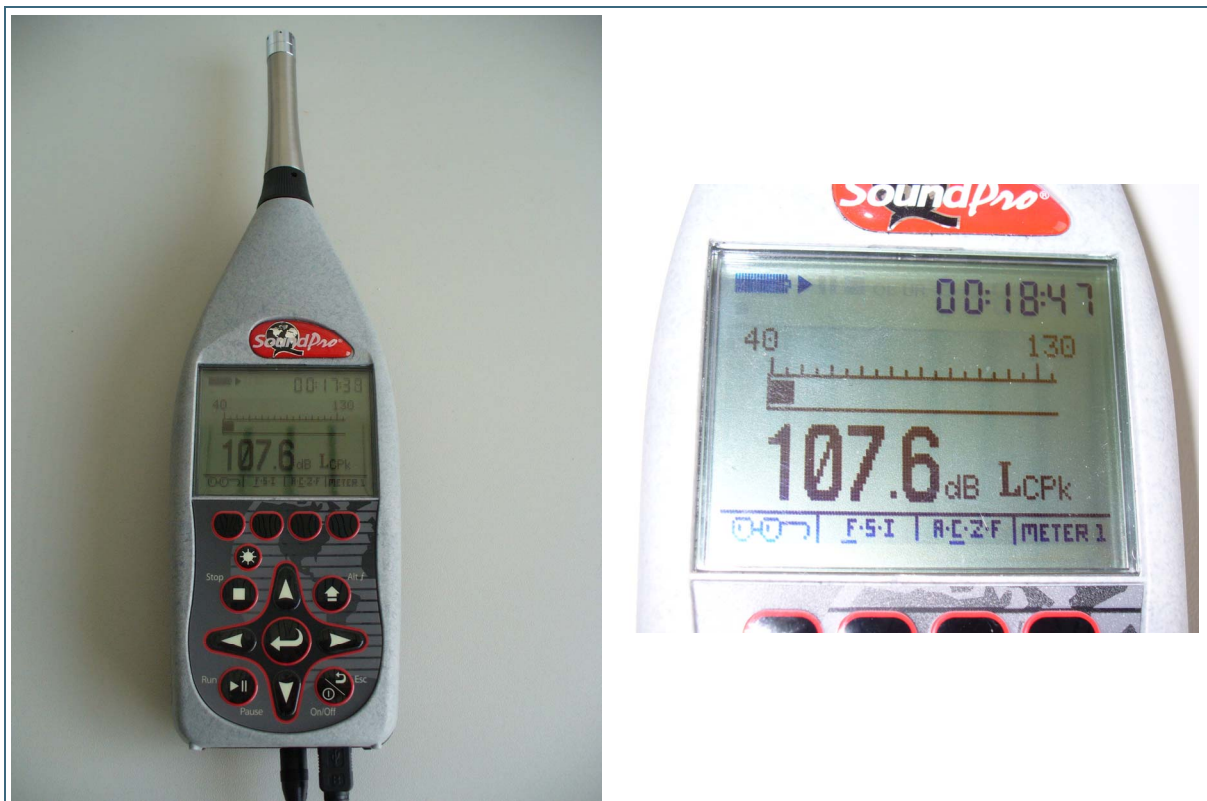
Abb. 9: Messsystem SoundPro (links) von Quest Technologies (Airflow) und Schallpegelanzeige im Display (rechts)
