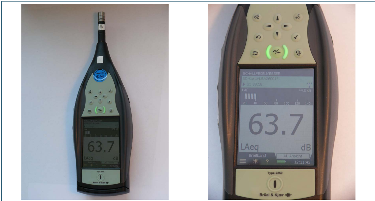
Abb. 1: Schallpegelmessgerät 2250 Light (links) von Brüel & Kjær und Schallpegelanzeige im Touchdisplay
