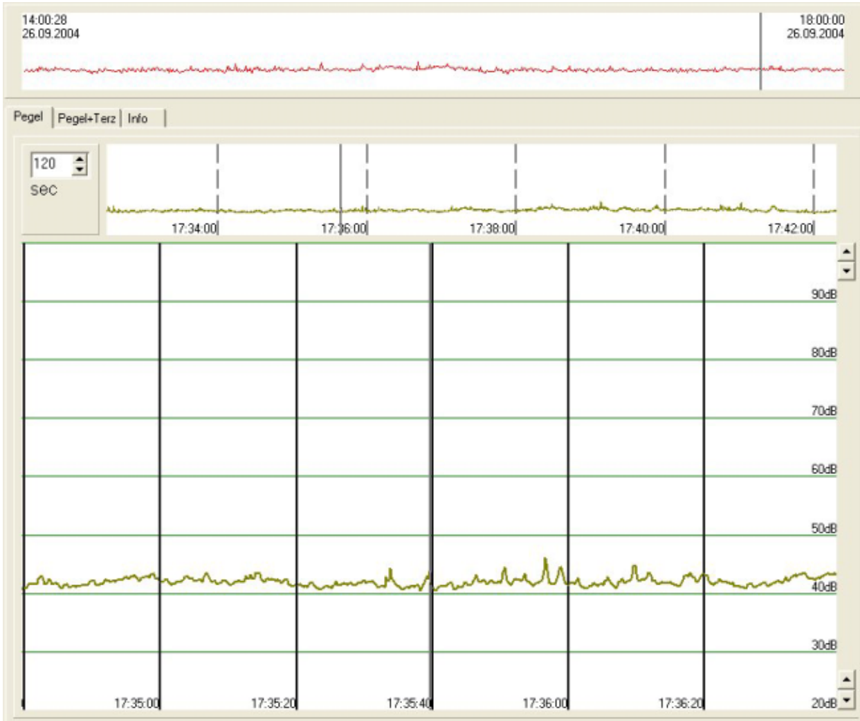
Bild 38 Pegelschrieb vom Sonntag, 26.09.2004: kein Betrieb auf dem Bolzplatz. Oben: Übersicht 14.00-18.00 Uhr; Mitte: 10-Minuten Ausschnitt; Unten: Detail (2 min)
