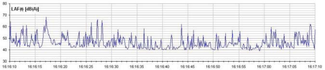
Bild 16 Schallpegelverlauf eines typischen Streetball-Spiels (Spiel 3:2 auf Tartanbelag) gemessen seitlich in 15 m Entfernung von der Spielfeldmitte: L_{WA} = 84 \text{ dB(A)} , L_{WAFmax} = 99 \text{ dB(A)} ; während des abgebildeten Zeitraums wurden folgende Ereignisse registriert: 32mal Ball tippen, 9mal lautes Rufen, 3mal Korb von Ball getroffen
