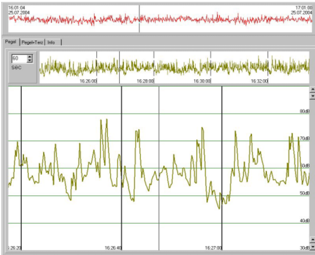
Bild 46 Pegelschrieb Anlage S01, Sonntag, 25.07.2004. Oben: Übersicht 16.00 bis 17.00 Uhr; Mitte: 10-Minuten Ausschnitt; Unten: Detail (60s)
