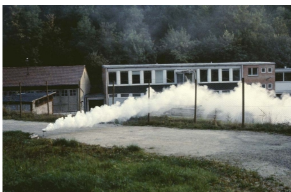
Abb. 2: Rauchgasexperimente geben Aufschluss über die Kaltluftströmung am Messort.
