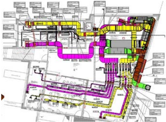
Abb. 15: Viatisschule – Lüftungsschema vor der planerischen Optimierung
