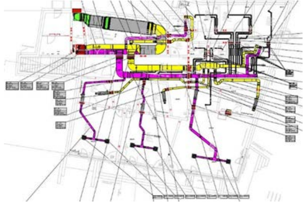
Abb. 16: Viatisschule – Lüftungsschema nach planerischer Optimierung
