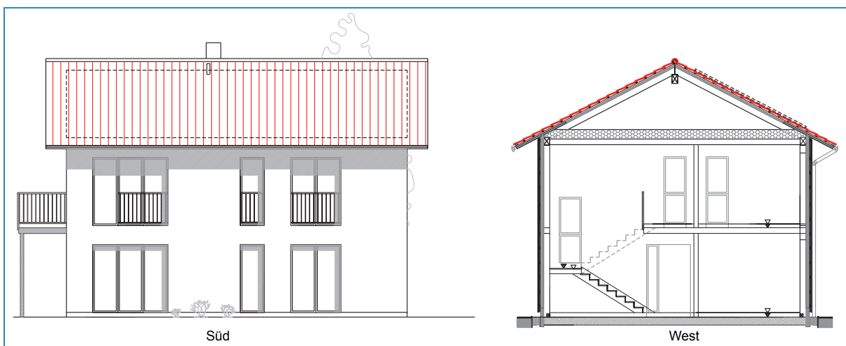
Abb. 2: Süd- und Westansicht (Schnitt) des untersuchten Einfamilienhauses
