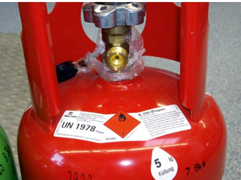
Eine richtig gekennzeichnete Flasche, befüllt mit dem Kältemittel Propan (R-290)
