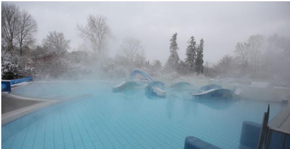
Abb. 14: Besonders im Winter geht über die Wasseroberfläche eines Außenbeckens viel Wärme verloren.
