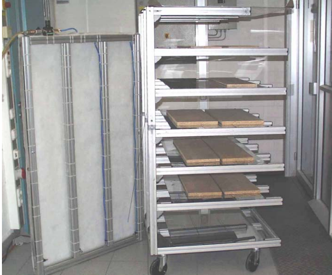
Abb. 22: Belüfteter Hordenwagen zur Trocknung von wasserlackbeschichteten Flachteilen mittels strömender Luft (Prototyp Fraunhofer IPA)
