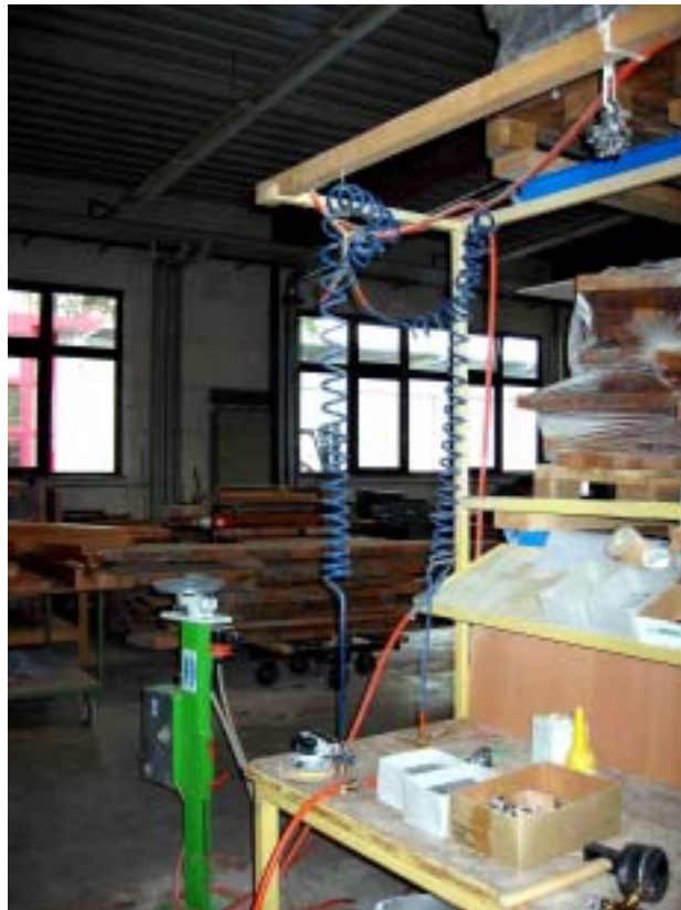
Abb. 15: Fließdruckmessung nach zu langer Zuleitung und Spiralschlauch
