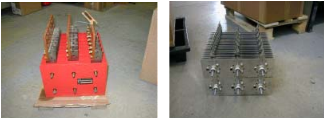
Abb. 2a + 2b : Selenplatten (links) – Silizium-Dioden –Nachbau (rechts)
