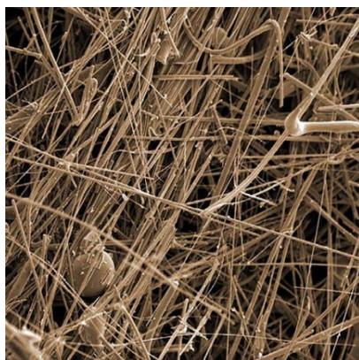
Abb. 3: Steinwolle, Bildbreite 50 µm
