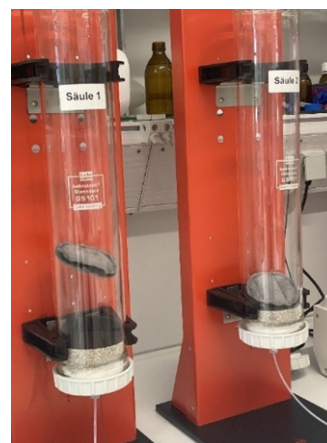
Abb. 42: Einbau des Aktivkohlevlieses auf „Bremsvlies“ und Filtersand.
