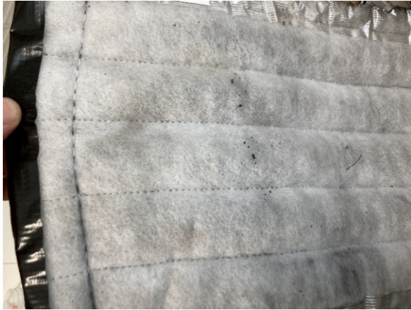
Abb. 39: Tektoseal Active AC (Aktivkohlevlies).
