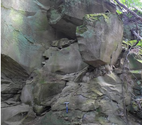
Abb. 13: Felswand im Schilfsandstein an einem Rutschhang westlich von Schillingsfürst: Hier bietet sich ein sowohl massiges als auch stark geklüftetes Erscheinungsbild mit großen, absturzgefährdeten Blöcken.
