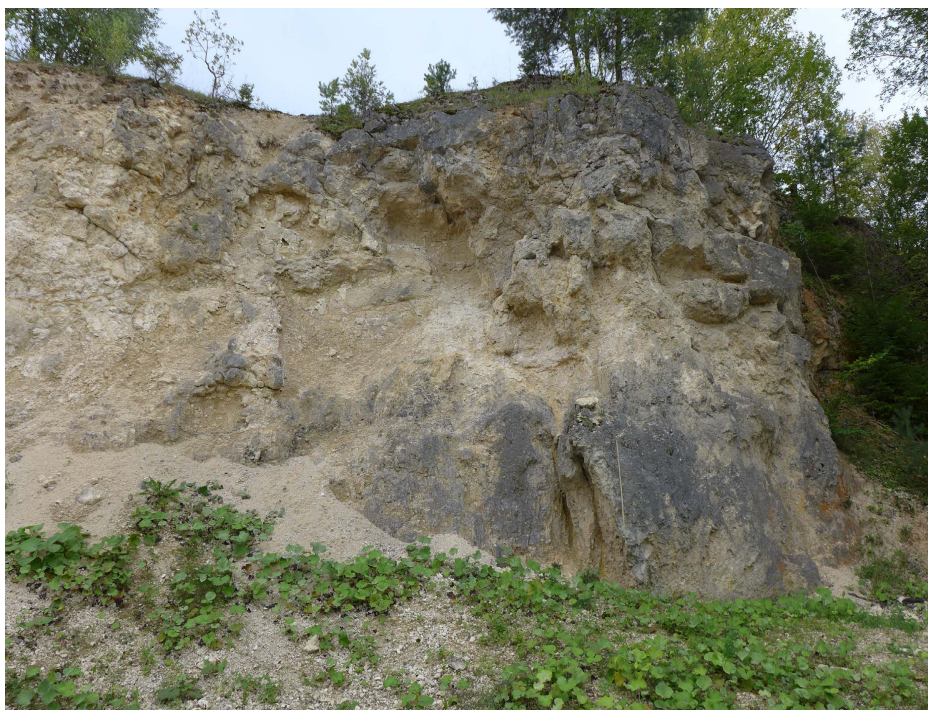
Abb. 10: Steinbruch nördlich von Zöschingen. Aufschlüsse dienen außerdem zur Blockgrößenbestimmung für die Modellierung von Sturzprozessen.
