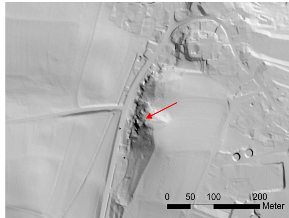
Abb. 3: Straßenanschnitt südwestlich von Diemantstein mit potentiellen Anbruchbereichen im Schattenbild
