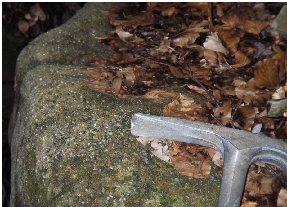
Abb. 16: Reiselsberg-Formation am Freibergsee (Oberstdorf). Die Gesteine der Rhenodanubischen Flysch-Zone sind intensiv verfault und teilweise stark mechanisch beansprucht. Ein wichtiger Vertreter ist die Reiselsberg-Formation (Reiselberger Sandstein). Sie besitzt sehr dickbankige (bis über 2 m Bankmächtigkeiten), mürbe und glimmerreiche Sandsteinlagen, in die dünne und glimmerreiche Tonlagen eingeschaltet sein können.
