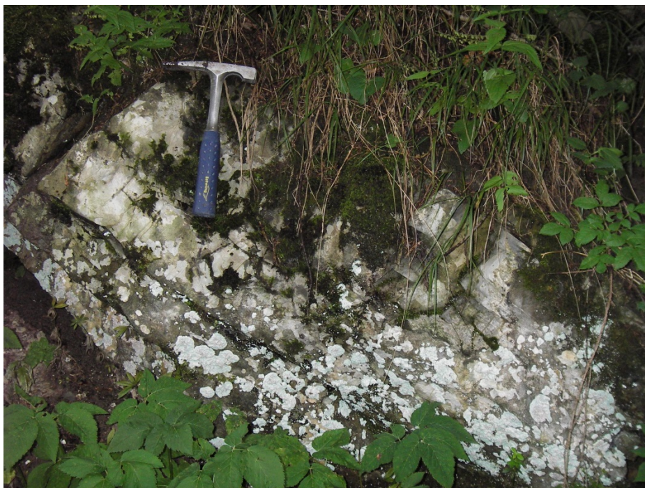
Abb. 15: Junghansschichten bei Oberstdorf (Trettachbrücke). In der Feuerstätter-Flysch-Zone sind die Junghansschichten als feinkörnige und engständige Wechselfolgen von Sandsteinen, Mergeln und Tonen mit kalkhaltigen Turbiditen bekannt. Aufgrund der genannten extremen tektonischen Beanspruchung sind auch diese Gesteine eng geklüftet. Bruchstücke mit Kantenlängen um 20 cm sind typisch.
