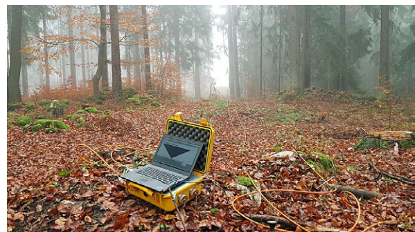
Abb. 31: Prozessieren der Messdaten am angeschlossenen Gelände-PC.
