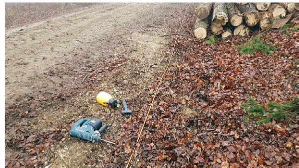
Abb. 29: Einbringen der Elektroden in den Untergrund.
