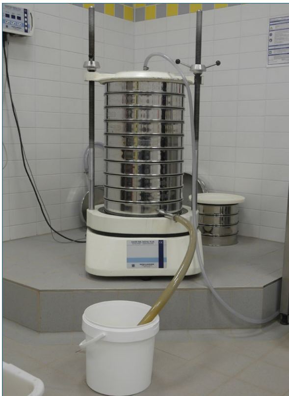
Abb. 24: Aufbau des Siebturmes mit übereinander gestapelten Siebeinsätzen.
