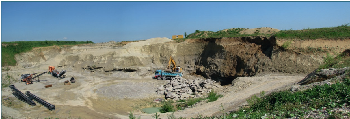
Abb. 32: Panoramafoto der Kiesgrube Adelshausen NW; rechts von Bagger und LKW Abbautiefstes 3 m unter Fahrsohle; horizontale Ausdehnung der sichtbaren Abbauwand ca. 150 m
