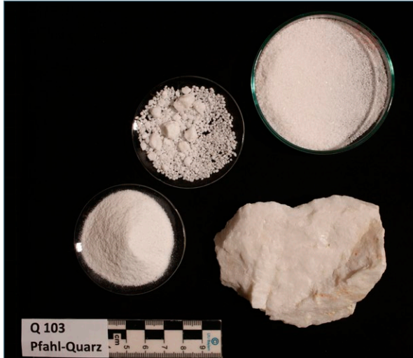
Abb. 13: Pfahl-Quarz (Probe Q 103; Steinbruch March / Regen) als Rohprobe (unten rechts) und in verschiedenen Aufbereitungsstufen (oben) bzw. als analysenfähiges Quarz-Konzentrat (unten links).
