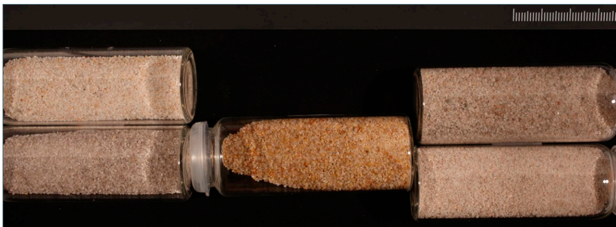
Abb. 11: Auswahl aufgereinigter Quarzkonzentrate aus mesozoischen Sandlagerstätten Nordbayerns.
