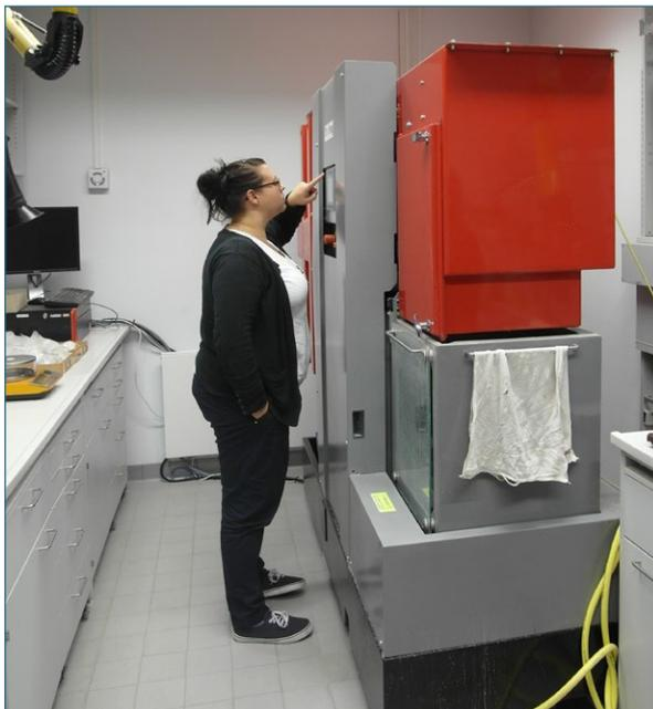
Abb. 22: Hochspannungs-Impulsfragmentierungs-Anlage (SELFRAG).
