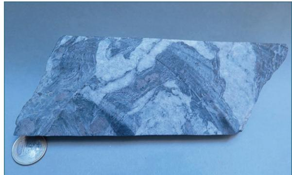
Abb. 16: Granat-Cordierit-Sillimanit-Gneis, Bohrung 7, Silberberg, Kernstück bei 79,0m Teufe.
