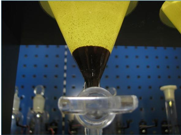
Abb. 24: Abtrennung von Schwermineralen mittels Sink-Schwimm-Verfahren im Scheidetrichter.
