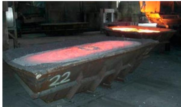
Abb. 2-4: Abstich des glühflüssigen Rohsiliziums (linkes Bild) und auskühlendes Roh-Silizium kurz nach dem Abstich bei über 1.600 °C (rechtes Bild)
