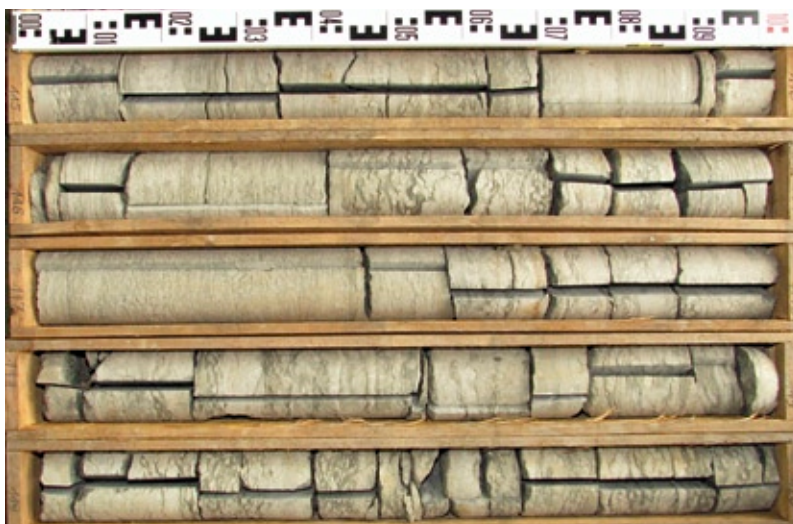
Abb. 4-7: Typischer Unterer Muschelkalk (Wellenkalk), Bohrung Gips 2, Bindlach, von links oben bis rechts unten: 115 m - 120 m
