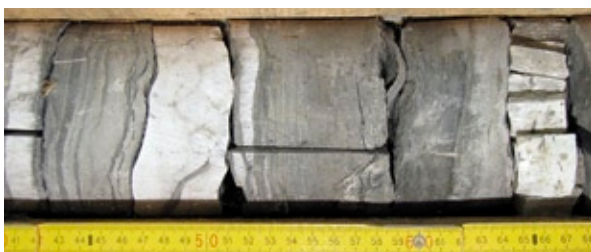
Abb. 4-17: Lagen von Fasergips. Gips 2, Bindlach: 99,4 m - 99,7 m
