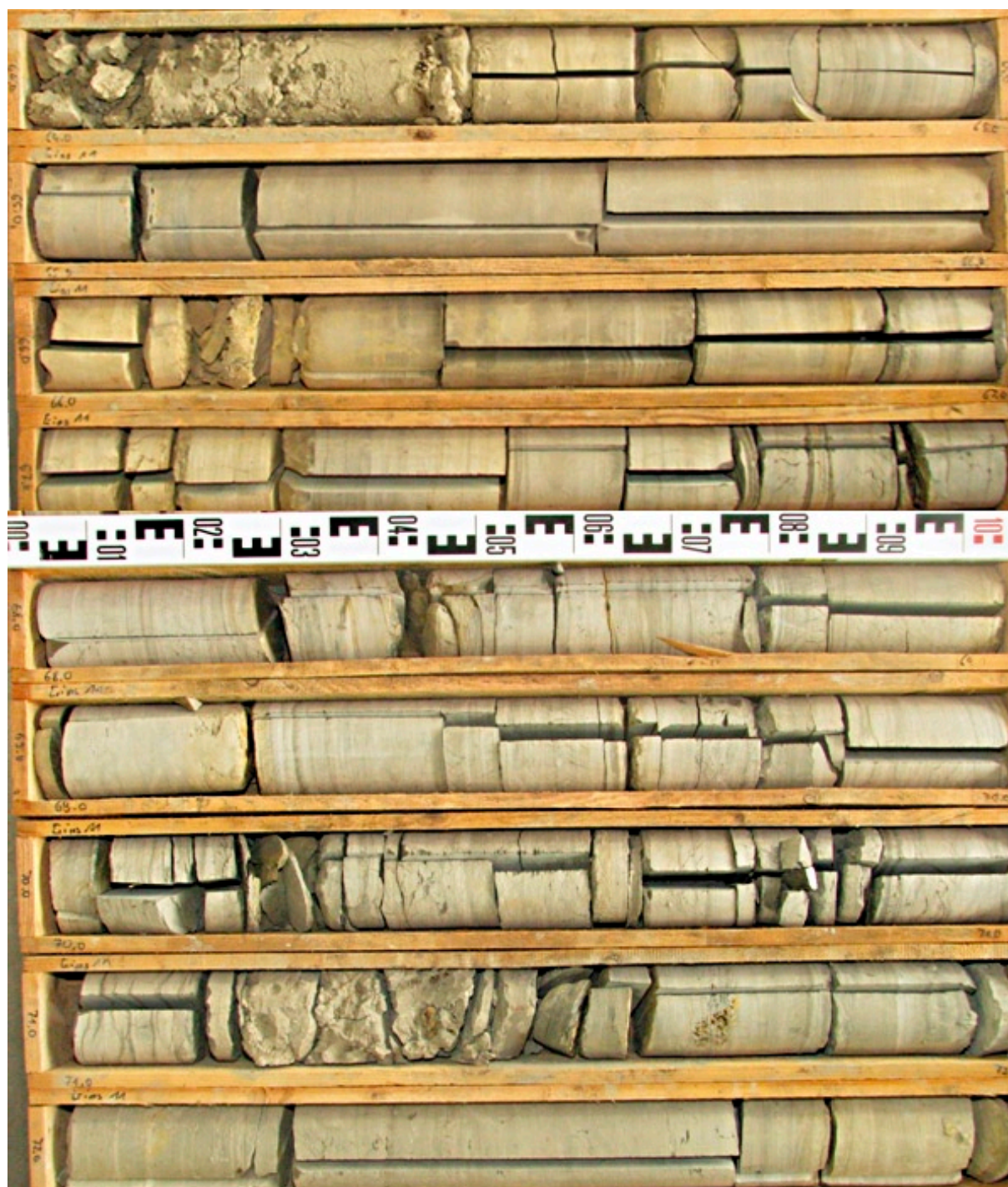
Abb. 4-8: Übergangsbereich mm/mu, Bohrung Gips 11, Gössersdorf, von links oben nach rechts unten: 64 m - 73 m: ab 64,5 m: Unteres Karbonat, ab 67,8 m Orbicularis-Schichten
