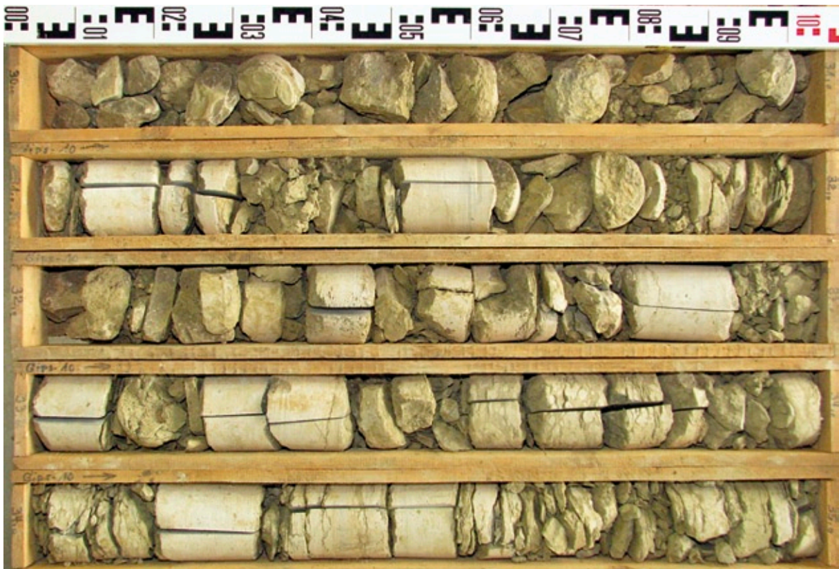
Abb. 4-2: Oberer Muschelkalk 1 (mo1), Bohrung Gips 10, Fölschnitz, von links oben bis rechts unten: 30 m - 35 m
