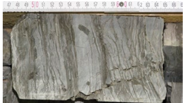
Abb. 4-12: Laminiertes Sulfat. Gips 13, Ahlstadt, 86,5 m - 86,65 m
