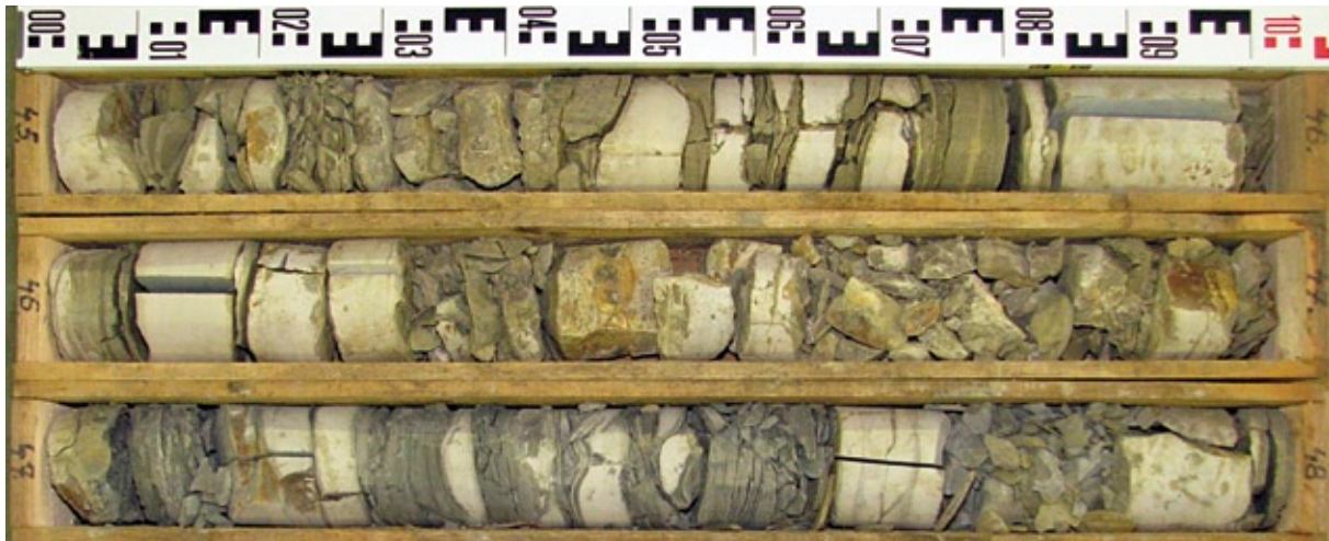
Abb. 4-1: Oberer Muschelkalk 1 (mo1), Bohrung Gips 7, Wötzelsdorf, von links oben bis rechts unten: 45 m - 48 m
