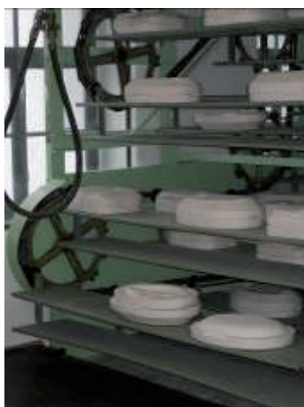
Abb. 5: Vertikaltrockner in einer Gießerei zur rascheren Trocknung von nach dem Gießvorgang durchfeuchteter Formen.
