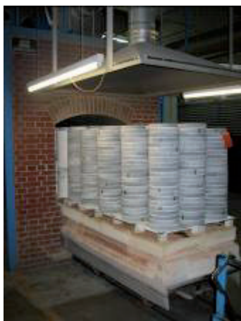
Abb. 9: Einfahrt eines Glattbrand-Tunnelofens; Schubwagen beladen mit Stapeln von Teller-Sparkapseln aus Siliziumkarbid.
