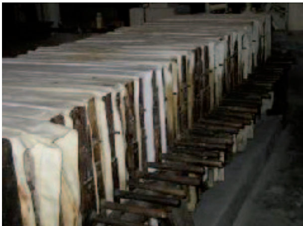
Abb. 4: Kammerfilterpresse (erkennbar sind die Kammern, welche beidseitig mit wasserdurchlässigen Filtertüchern ausgekleidet sind und die Hintereinanderschaltung der Kammern für die Druckentwässerung).
