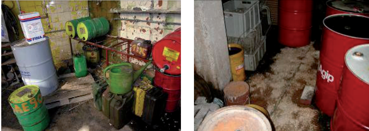
Abb. 34: Unsachgemäße Lagerung von Kraft- und Schmierstoffen, Ölen, etc.
