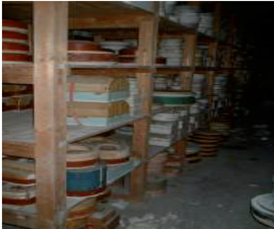
Abb. 6: Mutterformenlager einer Porzellanfabrik. Die Lager mit z. T. aus Verbundmaterial hergestellten Gegenständen sind schwierig zu beräumen und zu entsorgen.
