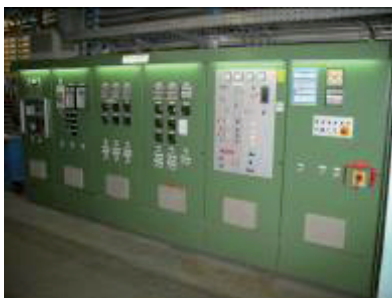
Abb. 25: Steuerung eines Tunnelofens. Die barometrische Steuerung der Ofenatmosphäre befindet sich in den linken Schränken.
