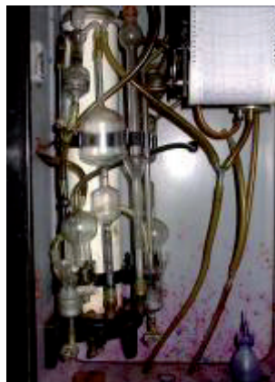
Abb. 26: Mit Quecksilber gefüllte Ausgleichsgefäße einer barometrischen Ofenluftsteuerung („Mono“).
