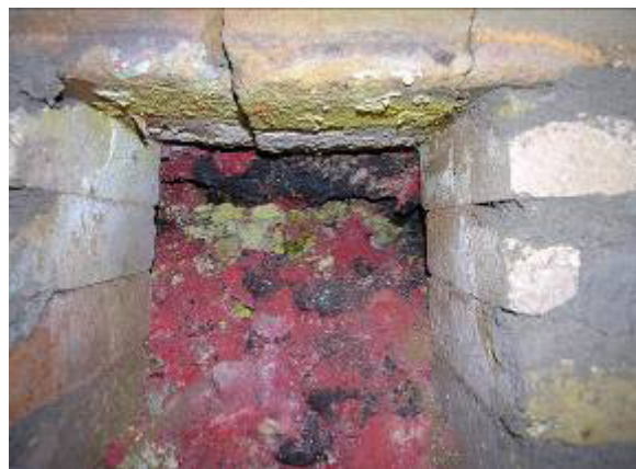
Abb. 13: Vollständig zugesetzter Regenerator (Bleimennige = rot, Arsen = gelb)
