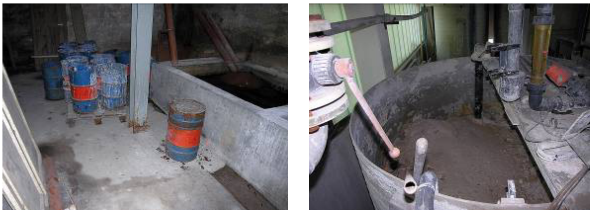
Abb. 18: Gebinde mit Restschlämmen (linkes Bild) und nicht entleerte Neutralisationsbehälter (rechtes Bild) auf einem Altstandort
