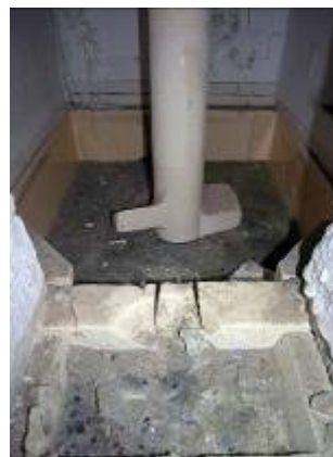
Abb. 4: Abschnitt der Läuterung mit keramischem Rührwerk
