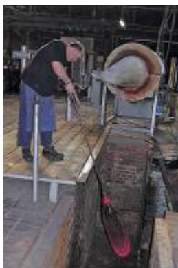
Abb. 7: Flachglasherstellung durch Blasen
