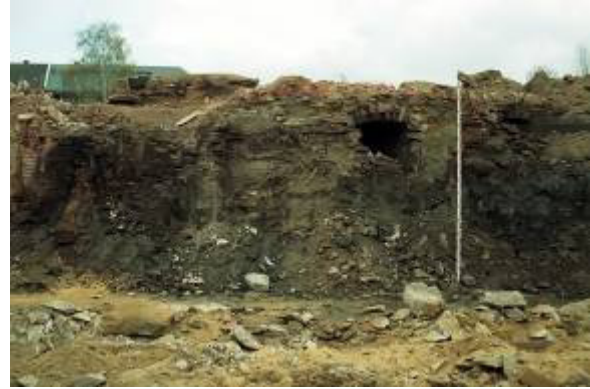
Abb. 16: Tiefgründig mit PAK und Phenolen (schwarz) imprägnierter Boden im Bereich der Befuerung mit Rauchzügen
