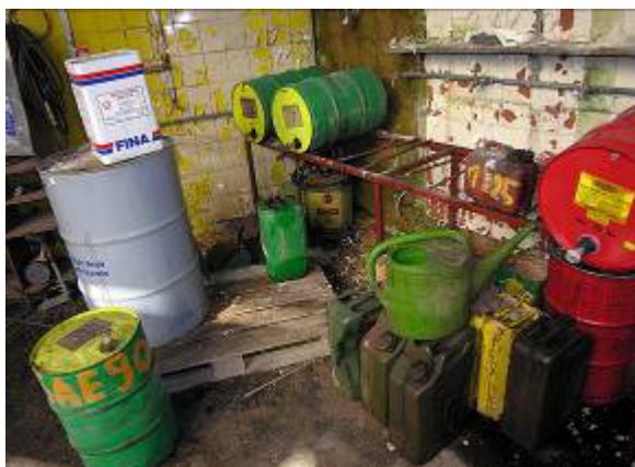
Abb. 19: Unsachgemäße Lagerung von Kraft- und Schmierstoffen, Ölen, etc.
