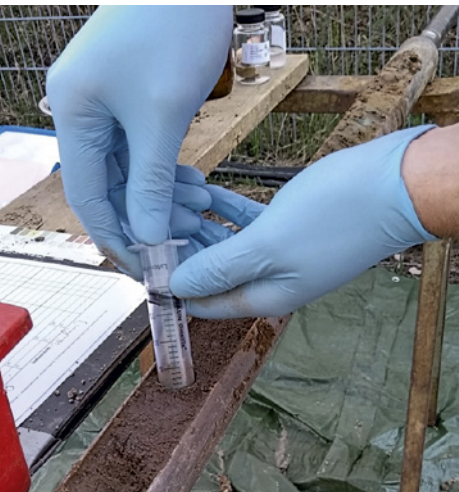
Untersuchung von Boden und Bodenluft auf Schadstoffe
