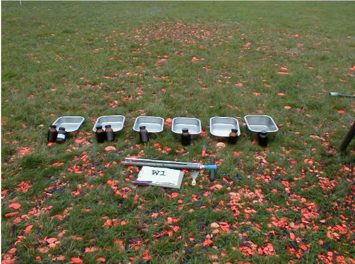
**Abbildung 5: Edelstahlwannen für die Probenhomogenisierung**
