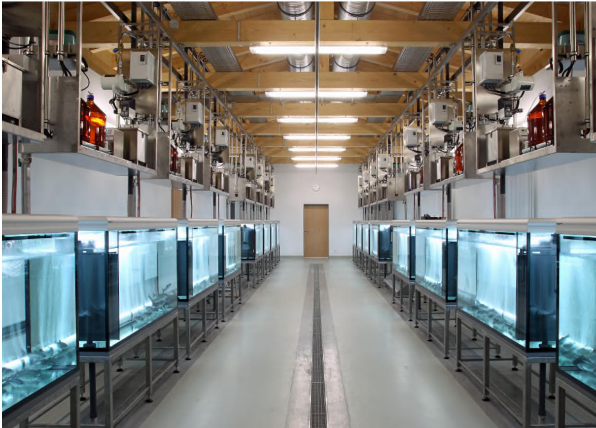
Abb. 1: Ökotoxikologische Versuchsanlage. In den 560-Liter-Testaquarien werden die Versuchs- und Kontrollfische im Durchfluss in Quellwasser gehalten.
