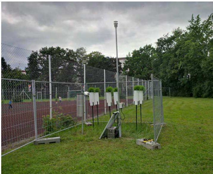
Abb. 33: Wetterstation, Graskulturen, Depositionssammler und PUF-Passivsammler am Messpunkt HER_03.
