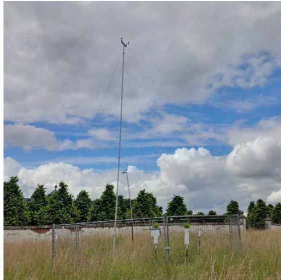
Abb. 4: Messpunkt MEM_05. Zu erkennen sind: Windmast, kleine Graskulturen, Bergerhoff-Becher und Passivsammler.
