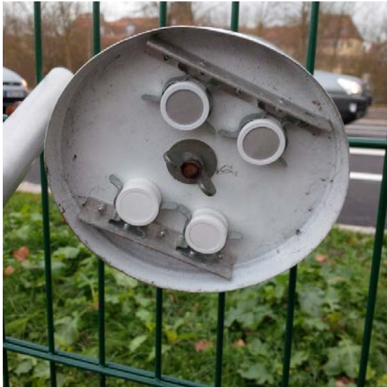
Abb. 3: NO 2 und NH 3 Passivsammler unter Wetterschutzdach an der Spitze der 3,5 m langen Haltestange.
