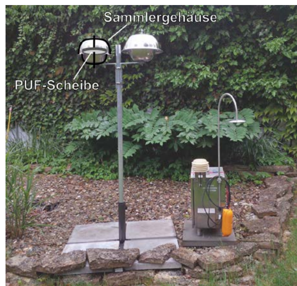
Abb. 30: Parallelmessung der PCB-Luftkonzentration am Messpunkt LAW_01, mit zwei Passivsammlern (links) und einem Aktivsammler (rechts).
