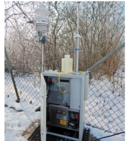
Oben: Messgerät zur Erfassung der Anzahl ultrafeiner Partikel
