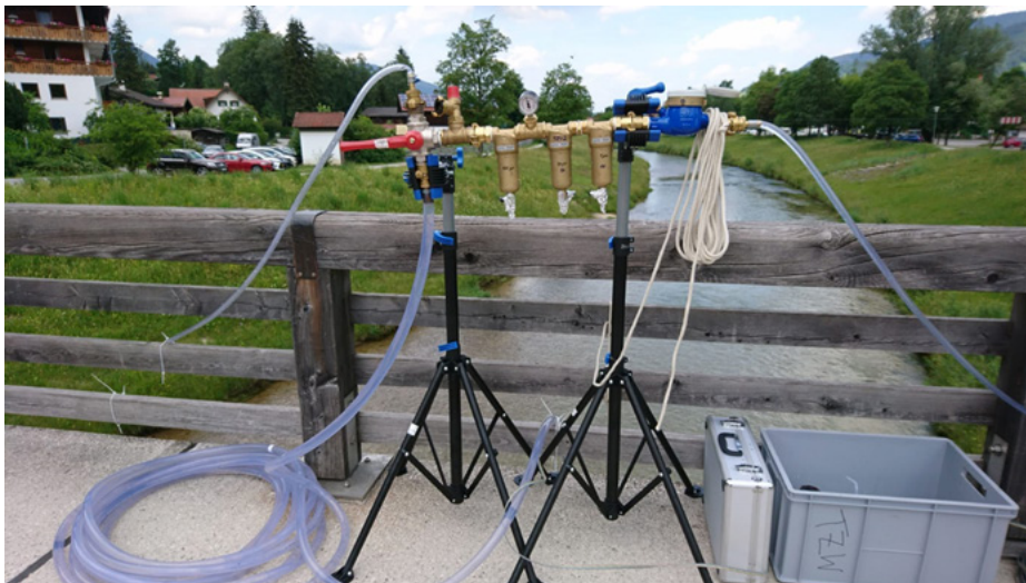
Abb. 1: Zur Probenahme wird eine definierte Wassermenge (> 500 l) über eine Filterkaskade gepumpt.
