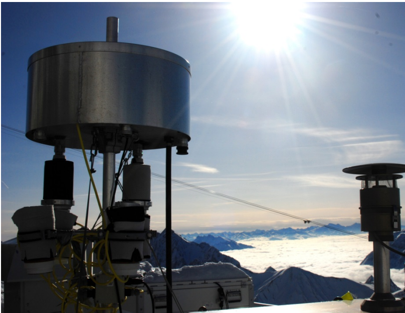
Abb. 10: Probenahmegeräte zur Bestimmung der Konzentrationen schwer abbaubarer Schadstoffe in der Luft an der Umweltforschungsstation Schneefernerhaus (UFS) an der Zugspitze
