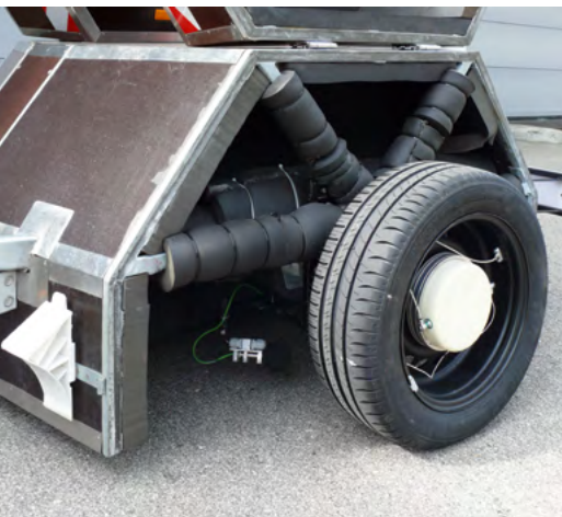
Blick in den geöffneten, schallgedämmten Radkasten mit montiertem akustischen Torus-Messgerät (ATMG) auf der Felge (oben)
