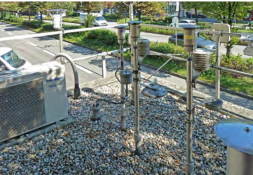
Die stark befahrene Landshuter Allee in München ist ein Messschwerpunkt des LfU. Die dortige Messstation erfasst auch die \text{NO}_2 -Konzentration in der Luft.
