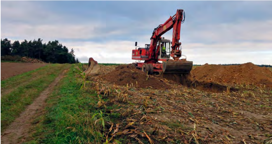
Baggerschurf zur Exploration von SEE-höffigen Quarziten im Fichtelgebirge
