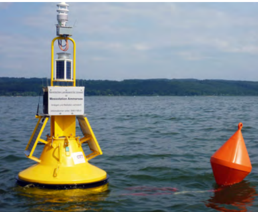
Die Messboje des LfU misst die Wassertemperatur des Ammersees in insgesamt 16 verschiedenen Tiefen.
