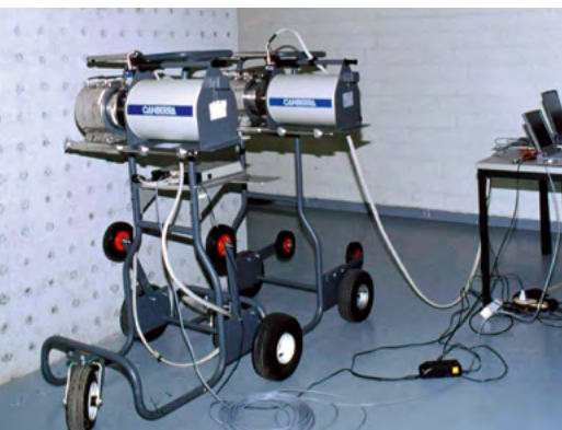
Qualitätssicherung der In-Situ-Gammaspektrometrie durch Vergleichsmessungen am Kulmbach-Regensburger In-Situ-Kalibrier-Phantom
