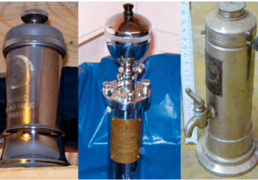
Antiquarische, radioaktive Radium-Emanatoren im Schrott lösen immer wieder Alarm aus bei Portalmessanlagen auf Schrottplätzen.
