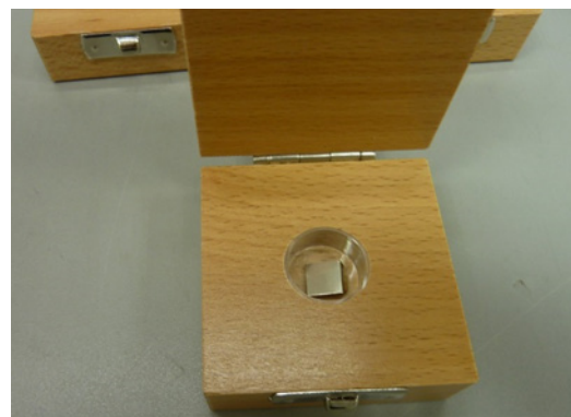
Abb. 21: Zertifiziertes Kalibriergewicht in Aufbewahrungskasten
