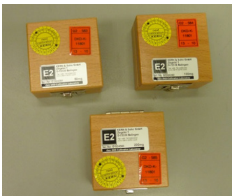
Abb. 20: Aufbewahrungskästen der Kalibriergewichte mit aufgeklebten Zertifikaten
