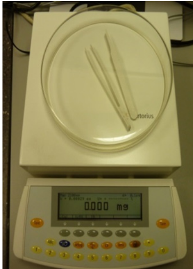
Abb. 13: Elektronik-Einheit der Ultra-Mikrowaage SE-2F mit Anzeige- und Tastenfeld (auf der Elektronik-Einheit sind zwei PTFE-beschichtete Pinzetten in einer Petrischale zu sehen)
