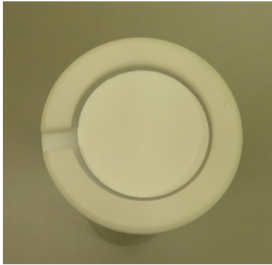
Abb. 2: Leerfilter in Filterhalterbasis
