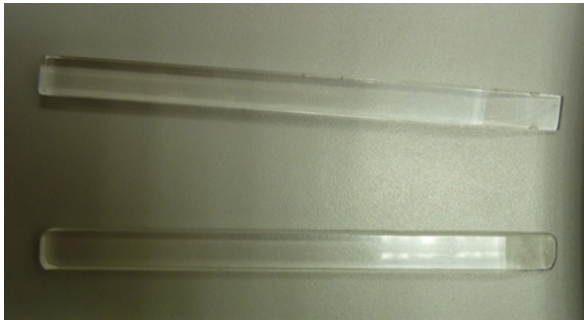
Abb. 24: Kunststoffspatel zum Öffnen des Filterhalters
