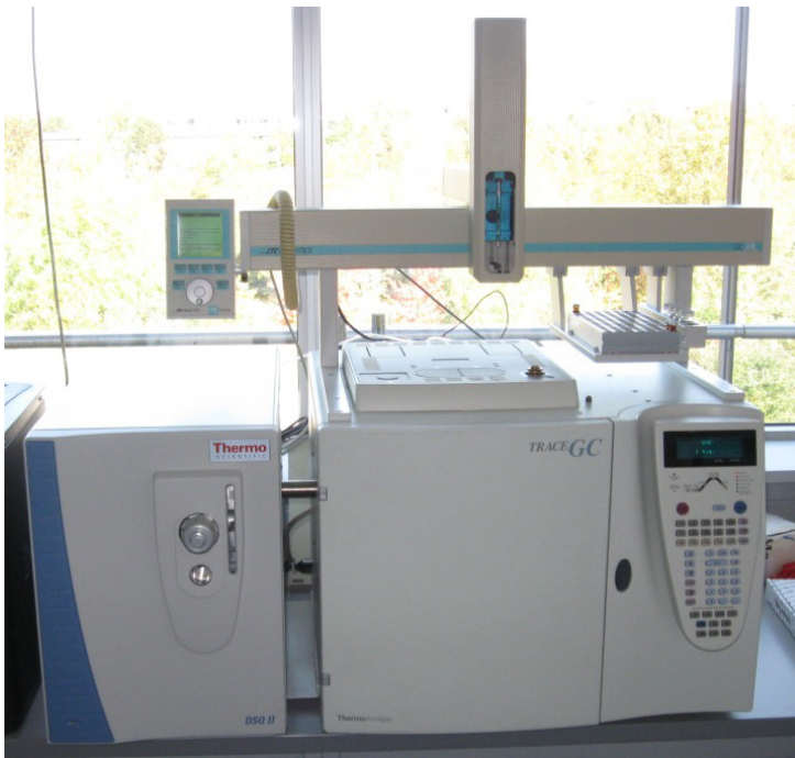
Abb. 1: GC-MS-System (Trace-GC gekoppelt mit DSQ II-MS, beide ThermoFisher Scientific)
