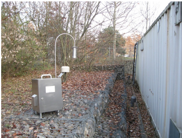
Abb. 9: Kleinfiltergerät mit U-förmigen Ansaugrohr und Probenahmekartusche, Betriebshof LfU Augsburg
