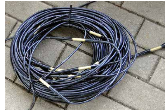
Die rund 80 Meter lange Temperaturmesskette bildet das Herzstück der Messboje. Sie hängt senkrecht unter der Boje und reicht bis zum Grund des Sees.
