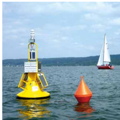
Bild links: Mit dem Arbeitsschiff „Alfons Goppel“ wurde die Messboje eingesetzt. Bild rechts: Die Messboje im Ammersee liefert mehrmals täglich Daten zur Wassertemperatur.
