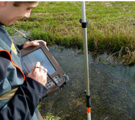
Kartierung der Gewässerstruktur: Als Hilfsmittel werden die Software „GSKmobil“ auf einem Tablet-PC sowie ein Teleskopstab verwendet.
