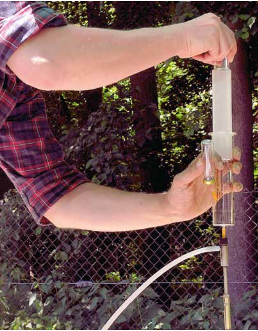
Entnahme der Bodenluftprobe aus Messgestänge zur Befüllung eines Headspace Vial mittels Spülverfahren
