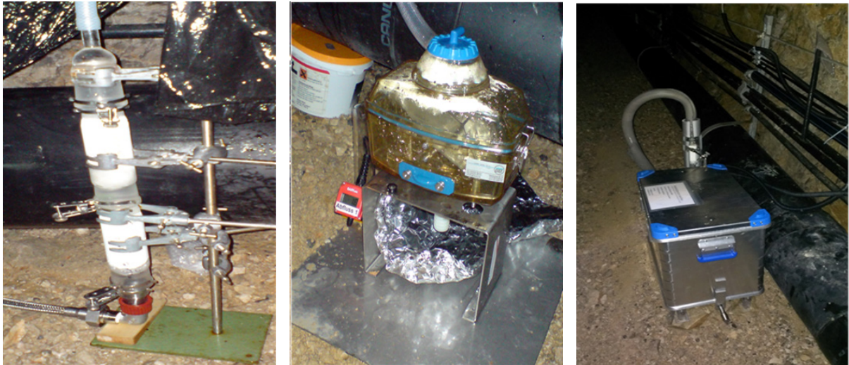
Abb. 3: Sammeleinrichtung und Durchflussmeter für die im Wasser gelösten POP (links), integriert in die Probenahmebox (rechts)
