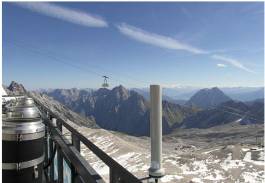
*Auch auf der Zugspitze wird seit September 2012 mit einer neuen Messsonde regelmäßig die Ortsdosisleistung ermittelt.*
