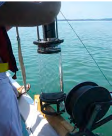
Wasserschöpfer zur Entnahme von Wasserproben
