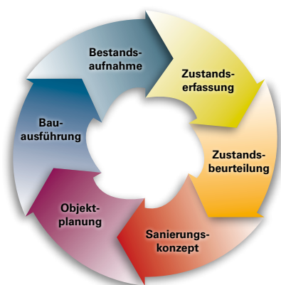
Sechs Arbeitsschritte zur erfolgreichen Kanalsanierung
