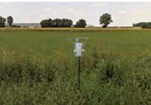
Messbecher zur Bestimmung des Staubniederschlages und der Schwermetalldeposition
