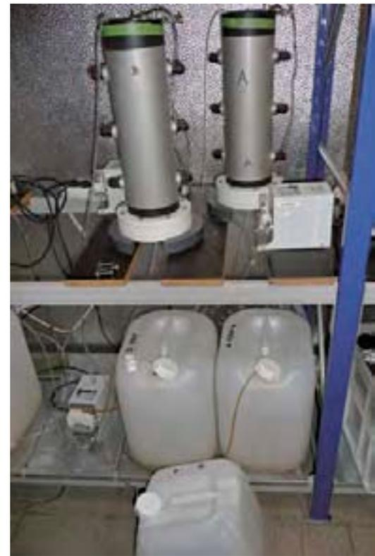
*Versuchsaufbau zum Verhalten von Triazolen im Boden. Die Stahlzylinder enthalten Boden aus einer Flussaue. Schlauchpumpen fördern triazolhaltiges Wasser aus dem schräg stehenden Kanister auf die Bodenproben im Zylinder. Das Sickerwasser wird in die Kanister im Regal geleitet. Füllstandsmessröhrchen im oberen Teil der Zylinder steuern die Schlauchpumpen.*
