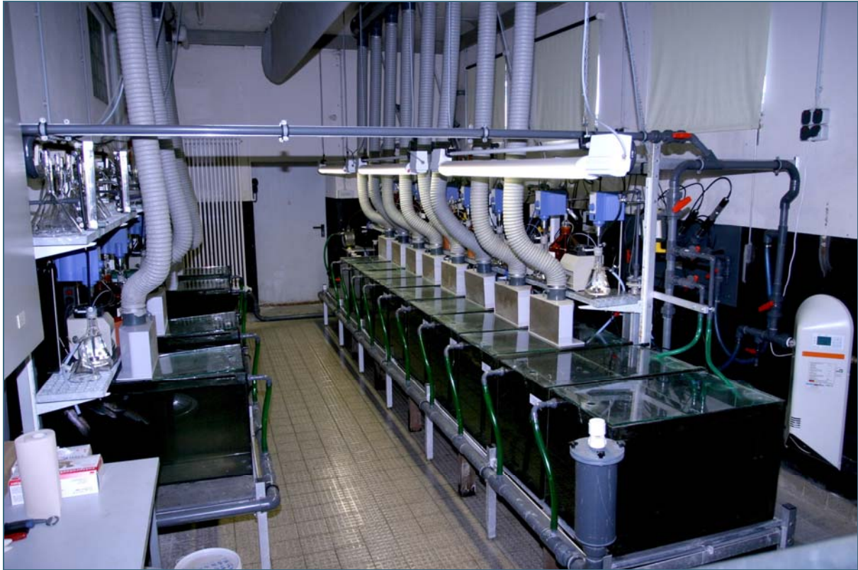
Abbildung. 3: Testanlage zur Exposition von Regenbogenforellen
