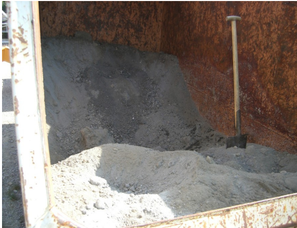
Abb. 8: Stabilisat aus Biomasse-Aschen-Filterstaub im Container
