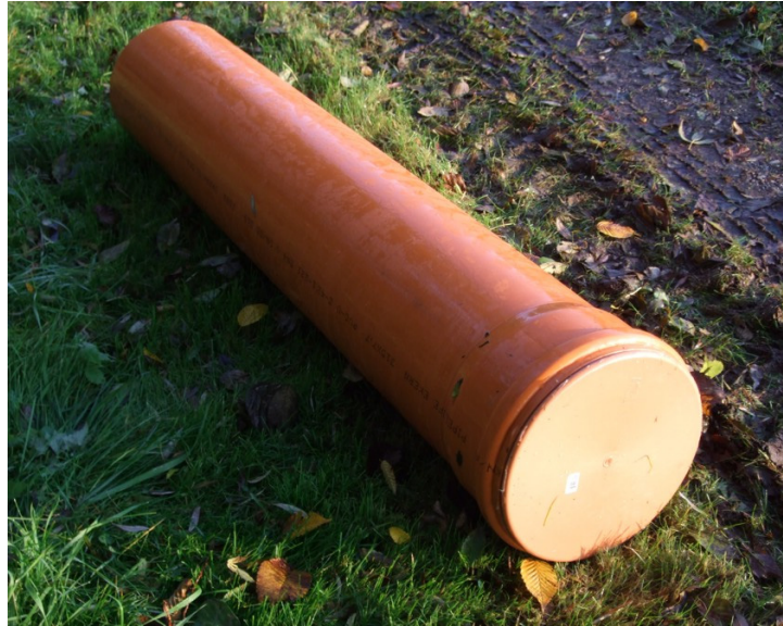
Abb. 2: KG-Rohr DN 300, am Fuß mit Deckel verschlossen
