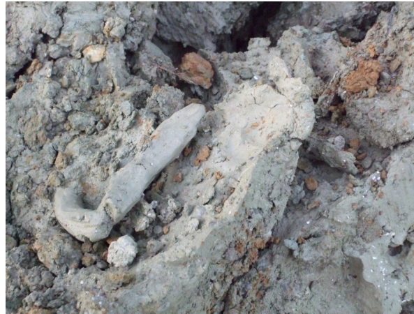
Abb. 5: Mergel vor dem Einbau mit Ausrollprobe
