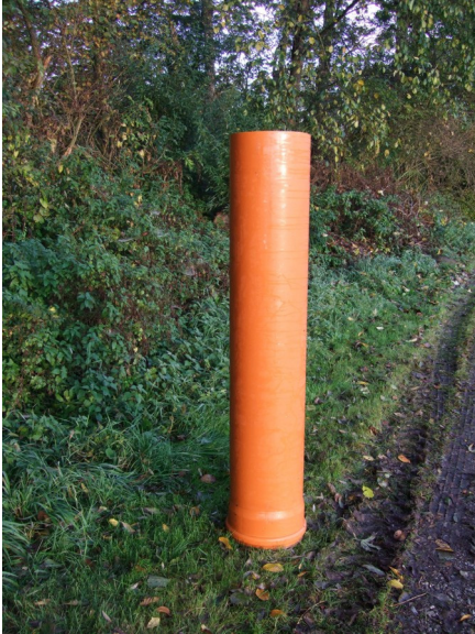
Abb. 1: KG-Rohr, 1,7 m, DN 300
