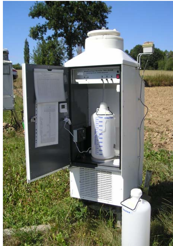
Abb. 5: Elektrisch gekühlter ‚wet only‘-Sammler.
