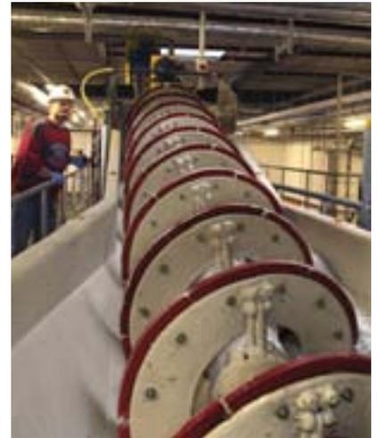
Die „Schnecke“ zur Trennung von Fest- und Flüssigstoffen vor der Aufbereitung der Halbleiterschichten.
