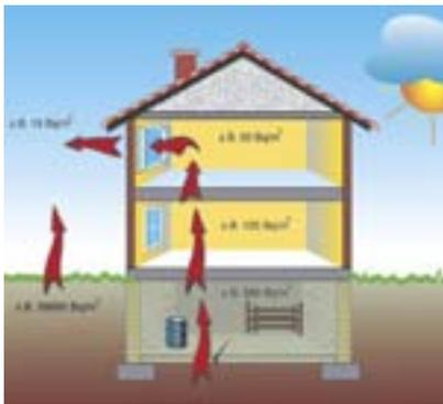
Beispielhafte Radonkonzentrationen in einem Gebäude. Radon dringt durch Risse und Fugen aus dem Boden in Kellerräume ein und vermischt sich dort mit der Raumluft.
