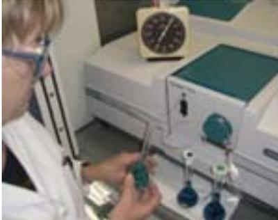
Die neu entwickelte, fotometrische Anilinbestimmung folgt einem exakten Zeitplan, da mit instabilen Lösungen gearbeitet wird.
