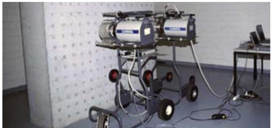
Zwei In-Situ-Spektrometer vor der vom LfU mitentwickelten Kalibrierwand. An ihr lassen sich Strahlungssituationen simulieren, Messgeräte testen und Messvorgänge trainieren.
