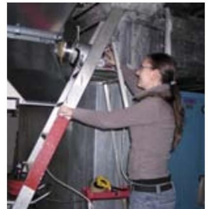
*Iodfilterkontrolle: Mit Hilfe eines Hochleistungsluftsammlers werden Proben aus dem Sammelkanal entnommen.*
