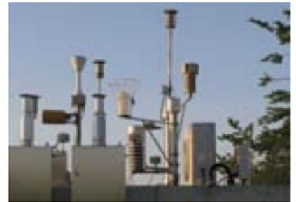
Probenahmeverrichtungen für Feinstaub und gasförmige Luftschadstoffe auf dem Dach einer Messstation
