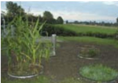
Mit Lysimetern wird eine mögliche Schadstoffverlagerung aus dem aufgebracht Klärschlamm in Boden und Grundwasser analysiert.
