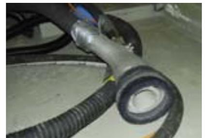
*Rückbau des Kernkraftwerkes Gundremmingen Block A: mittels „VacuBlast“-Strahlverfahren dekontaminierter Raum (Bild oben) und der „VacuBlast“-Strahlkopf (Bild unten)*
