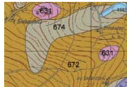
Die Geothermie-Rahmenbedingungskarten im Maßstab 1: 50 000 zeigen, welcher Anlagentyp in welchen Gebieten geeignet ist und wo mit Einschränkungen zu rechnen ist, wie z. B. in Wasser- und Heilquellenschutzgebieten oder in Gebieten mit bekannten Bohrrisiken wie z. B. im Karst oder bei ungünstigen Grundwasserverhältnissen.
